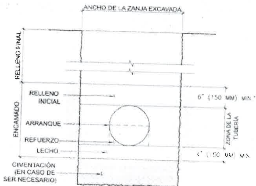
FIGURA 3: SECCIÓN TRANSVERSAL DE UNA ZANJA (ASTM D2321)
